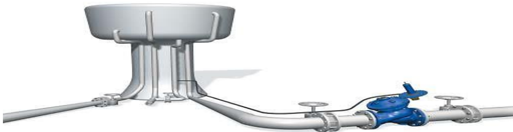
Figure 30 : Exemple d'une vanne altimétrique
