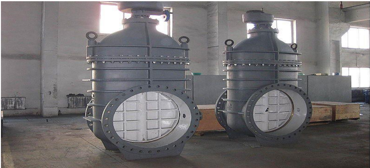
Figure 20 : Vanne opercule de grand diamètre
