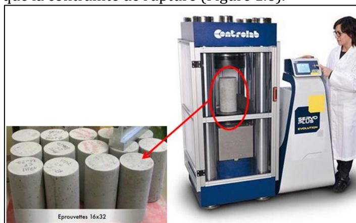
Figure. 1.6. Essai de compression sur éprouvette cylindrique
