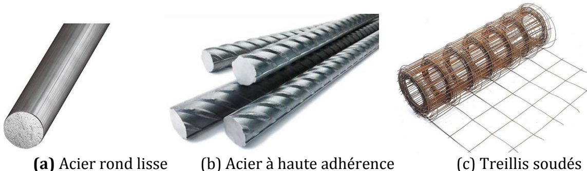
Figure. 1.4: Armature en acier utilisé en béton armé :
