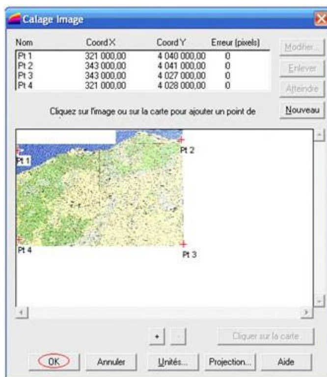
Figure V.12 : Calage d'une image raster : 6 ème étape : Calcul de l'erreur de calage
