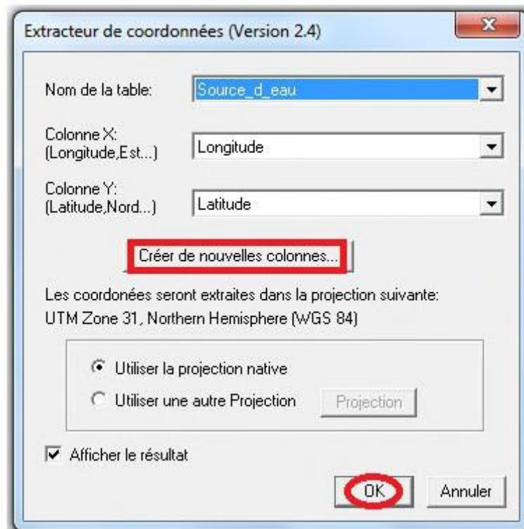
Figure V.49 : Extraction des coordonnées en créant des nouvelles colonnes d'extraction
