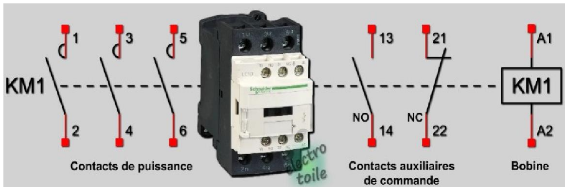
Figure 1:symbole d'un contacteur avec les contacts de commande et de puissance
