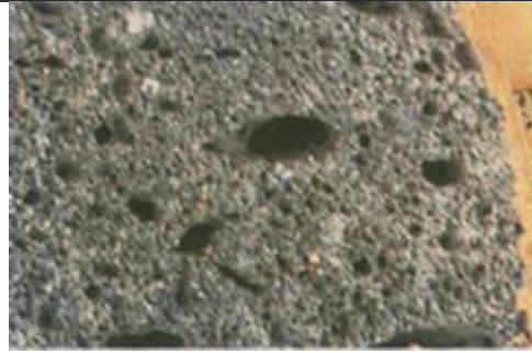
Granule d'argile expansée grossie et coupée
