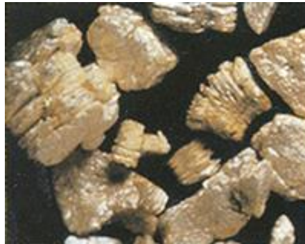
Granule de vermiculite grossi.
