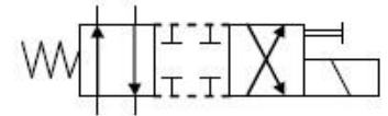
4/2 c de électrique, monostable, c de manuelle de secours et recouvrement positif (symbole détaillé)
