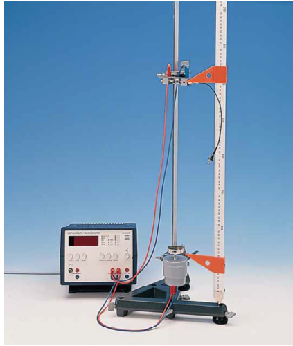
الشكل 2 : تركيب تجربة السقوط الحر
